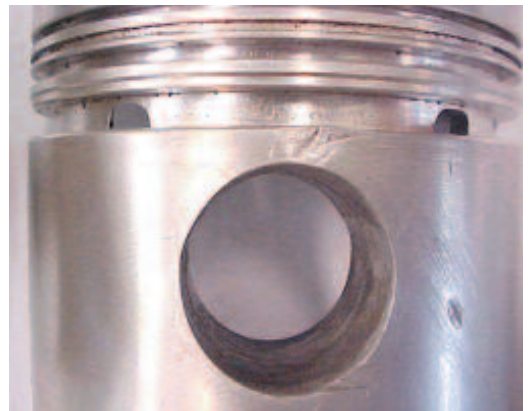
Fig. 2.14.4 Marca irregular próxima al cubo
