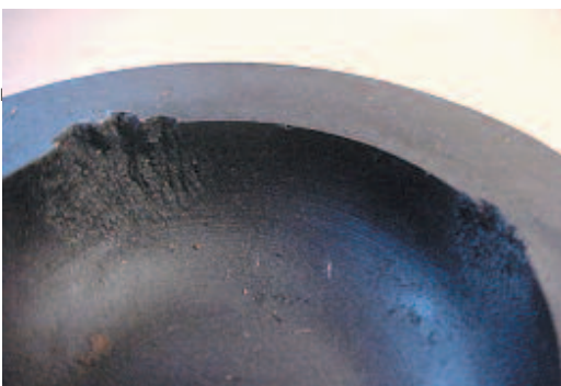
Fig. 2.7.1 Destrucción parcial de la cámara de combustión
