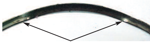
Fig. 3.4.1 Aro montado torcido
