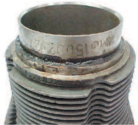
Fig. 4.1.4 Camisa montada con cola en la base inferior
