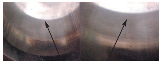
Fig. 5.3 Camisa "espejada" debido a la rotación constante
