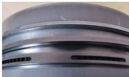
Fig. 3.5.6 Aro de la tercera ranura desgastado
