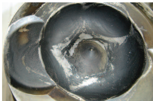
Fig. 2.6.3 Pulverización irregular del inyector
