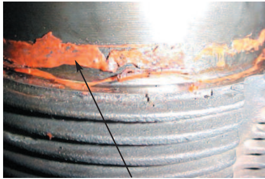
Fig. 4.1.2 Silicona en la base inferior de la camisa
