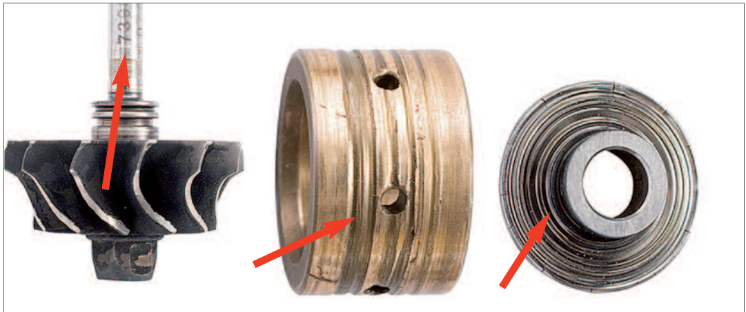
Fig. 13.1.1.5 - Eje del rotor, bancada radial y espaciador
