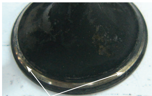
Fig. 11.9.1 Faja irregular de asentamiento
