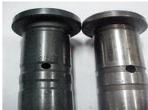
Fig. 12.1.1 – Desgaste en la región del cuerpo
