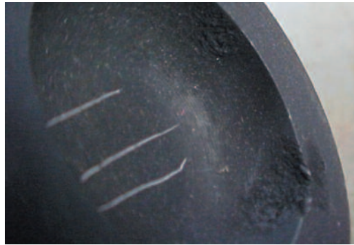
Fig. 2.7.2 Destrucción parcial de la cámara de combustión
