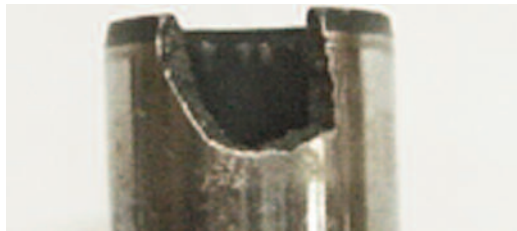
Fig. 12.4.3 – Detalle de la rotura del diámetro interno
