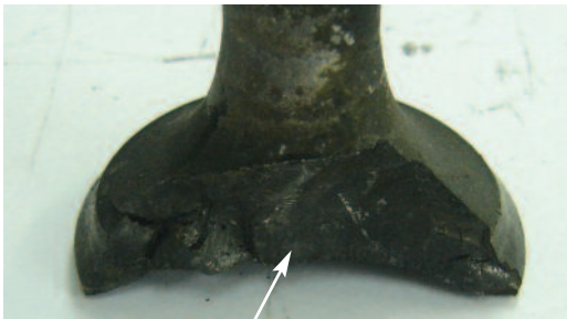
Fig. 11.6.1 Rotura de parte de la cabeza
