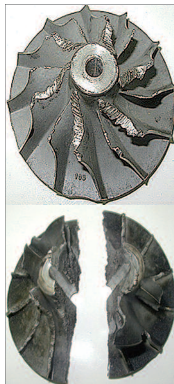
Fig. 13.2.2 – Rueda compresora con marcas de impurezas
