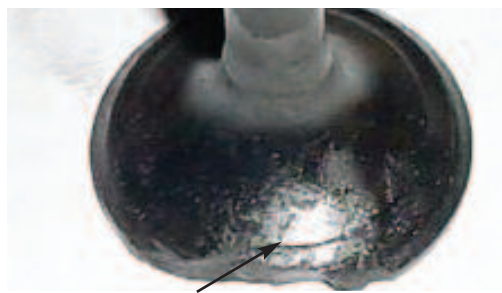
Fig. 11.5.1 Parte de la cabeza quebrada
