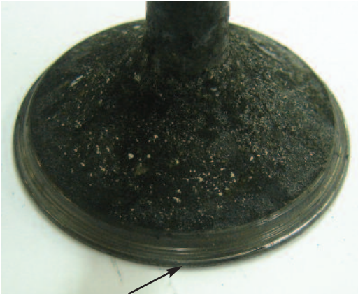
Fig. 11.2.2 Desgaste en la región del asiento de válvulas
