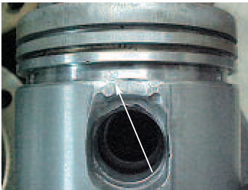
Fig. 6.2 Desgaste del pistón en la región del cubo y cabeza provocado por la traba
