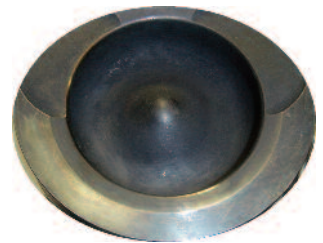
Fig. 2.13.4 Labrado del rebaje de válvulas
