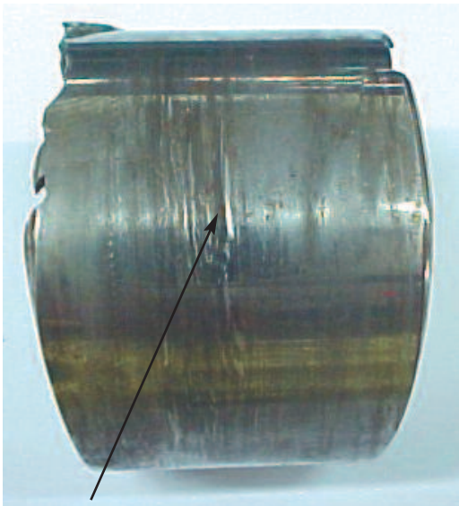
Fig. 10.3.1 Marca del encasquillado incorrecto
