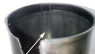
Fig. 6.3 Desgaste y raya provocados por partículas sólidas admitidas para dentro del cilindro
