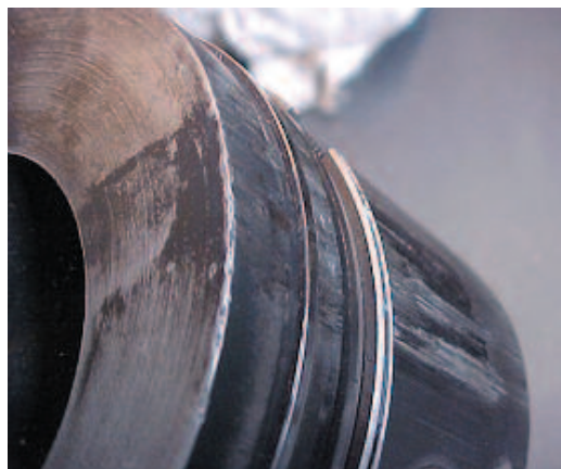
Fig. 2.6.6 Pulverización irregular del inyector
