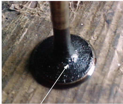
Fig. 11.9.3 Válvula de admisión con contaminación de costra de aceite lubricante debido a la holgura excesiva entre guía y vástago y/o deficiencia de retén/sellador
