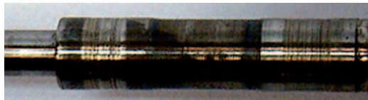
Fig. 13.1.2.2 – Rayas en el eje del rotor
