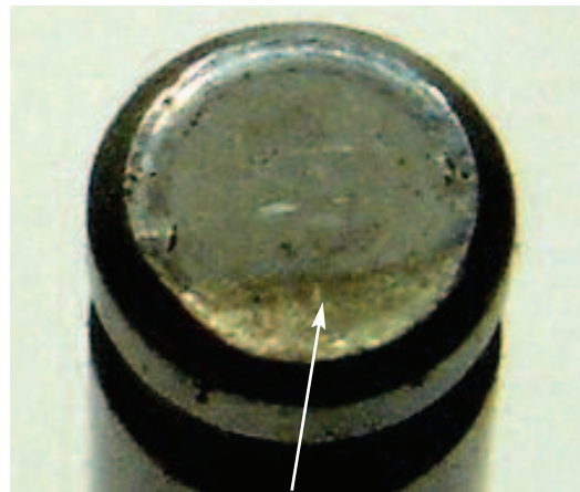
Fig. 11.9.5 Marcas que indican que la válvula no giró. Deficiencia del balancín
