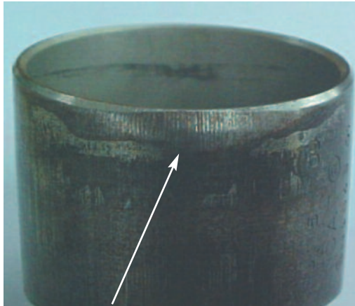
Fig. 10.3.2 Marca del encasquillado inclinado
