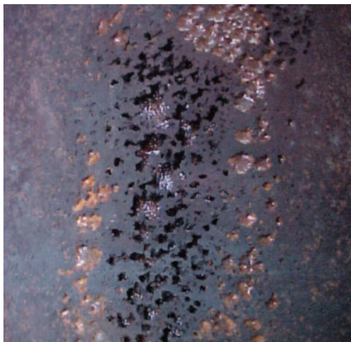
Fig. 6.1.2 Cavitación y escamas
