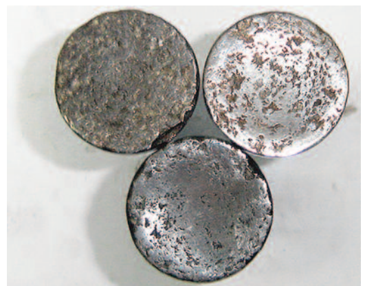
Fig. 12.3.1 – Desgaste y deformación de la base
