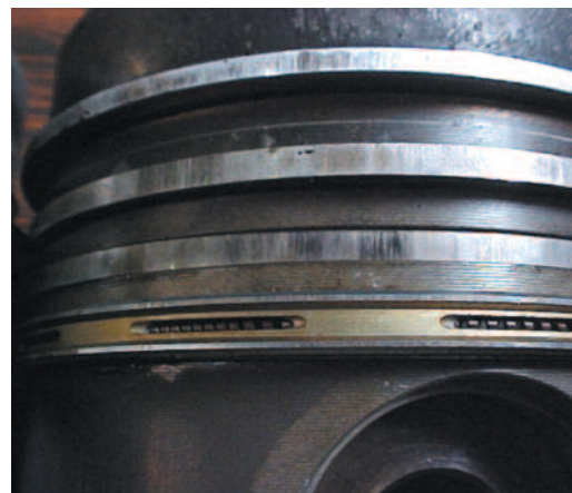
Fig. 2.7.5 Gripaje iniciado en la zona de fuego
