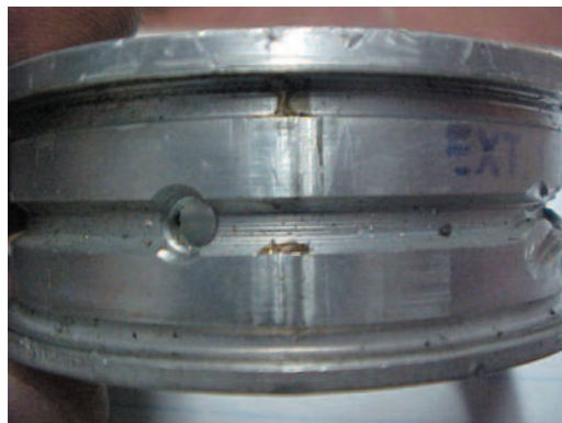
Fig. 8.13 Cola/adhesivo en el canal de lubricación externa del cojinete
