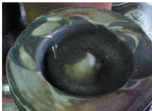
Fig. 2.6.4 Pulverización irregular del inyector
