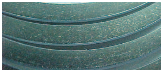
Fig. 3.5.5 Aro con partículas abrasivas en la cara lateral
