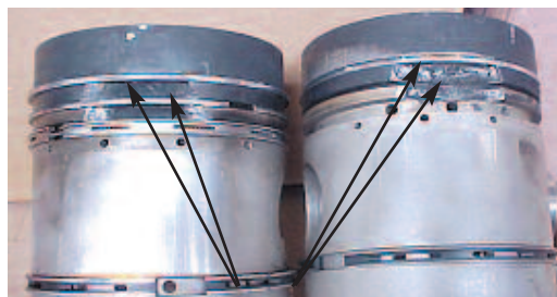
Fig. 2.15.3 Paredes entre ranuras fracturadas en pistones aplicados en motores Diesel
