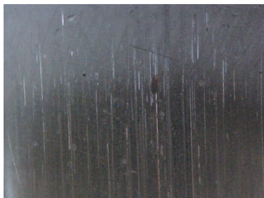
Fig. 8.2.7 Foto ampliada de las rayas y de los cuerpos extraños en el cojinete
