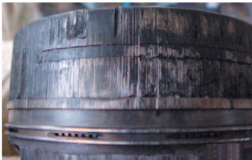
Fig. 2.7.8 Gripaje iniciado en la zona de fuego
