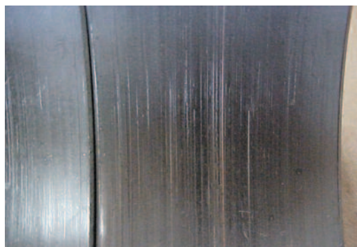
Fig. 8.2.6 Cojinetes de biela contaminados y con rayas circunferenciales
