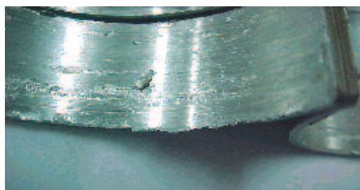
Fig. 7.6.2 Esgurrimiento de la aleación
