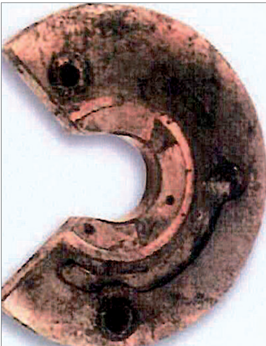
Fig. 13.3.1 – Contaminación de la bancada axial
