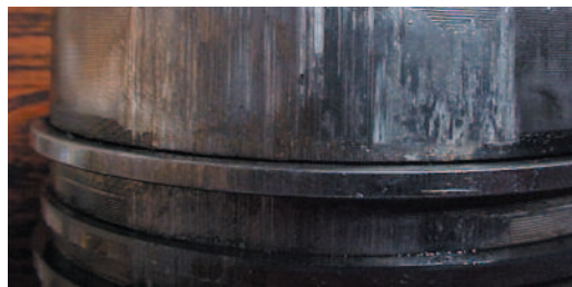
Fig. 2.7.4 Gripaje iniciado en la zona de fuego
