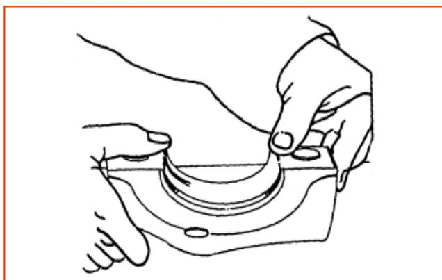
4. Lubrique los cojinetes superiores y los muñones de bancada y biela del cigüeñal.
