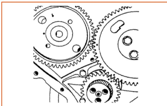
11. Posicione la chaveta del eje de la bomba inyectora en la ranura del engranaje, alineando las marcas de sincronismo con el engranaje intermedio.
