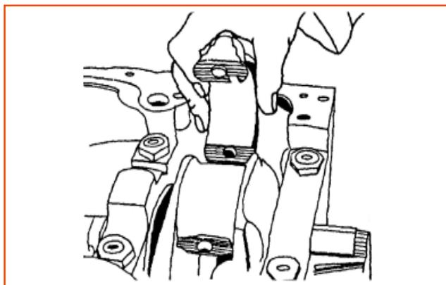
9. Verifique el juego lateral entre la biela montada y el muñón con reloj comparador: 0,216 - 0,368 mm.
