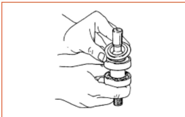
3. Verifique el diámetro externo del eje con su encaje en el rotor: 15,905 -15,918 mm.
