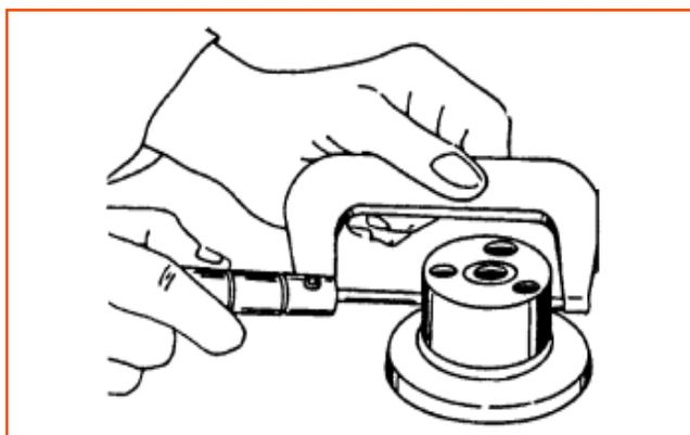
4. Verifique el espesor de la arandela de apoyo del árbol de levas: 5,49 - 5,54 mm.
