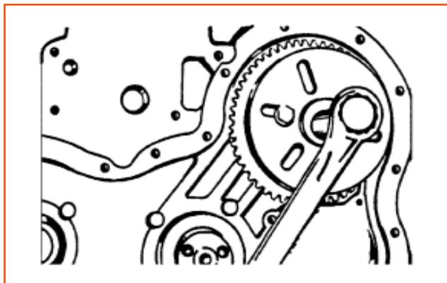
10. Retire la bomba inyectora.
